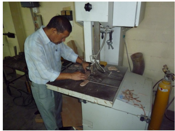
Fabrication du Denis-Browne splint et de chaussures de correction de CTEV
