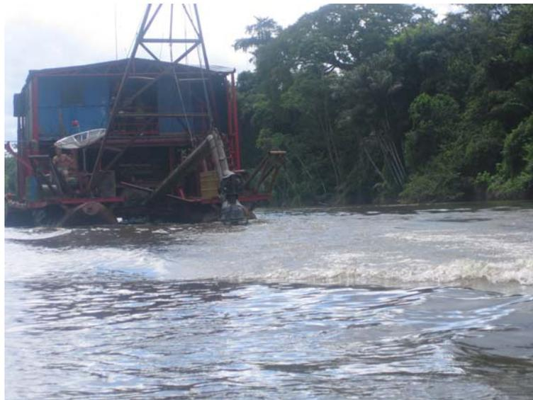
*Barge d'orpaillage sur le Maroni. Contrairement aux autres, ces orpailleurs-ci utilisaient un procédé qui leur permettait de récupérer le mercure pour l'utiliser une seconde fois et pour l'éliminer proprement à la fin.*
